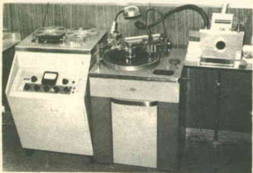
Da sinistra: l'incisore a nastro e l'apparecchio che procede all'incisione della matrice. L'apparecchio sulla destra, collegato con l'incisore della matrice, è una pompa aspirante che assorbe i trucioli che il bulino produce incidendo la matrice.
